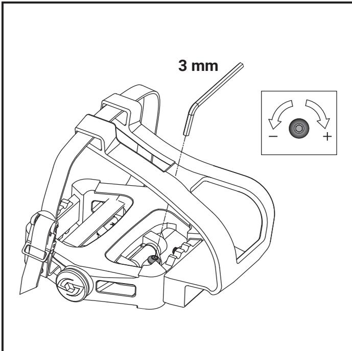
**Toe clip adjustment** / Einstellung des Pedalhakens / Ajuste de los rastrales /
